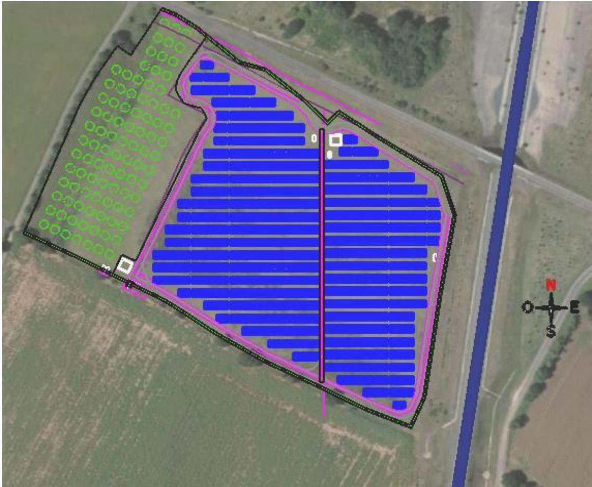
Figure 6 : Implantation des modules PV
